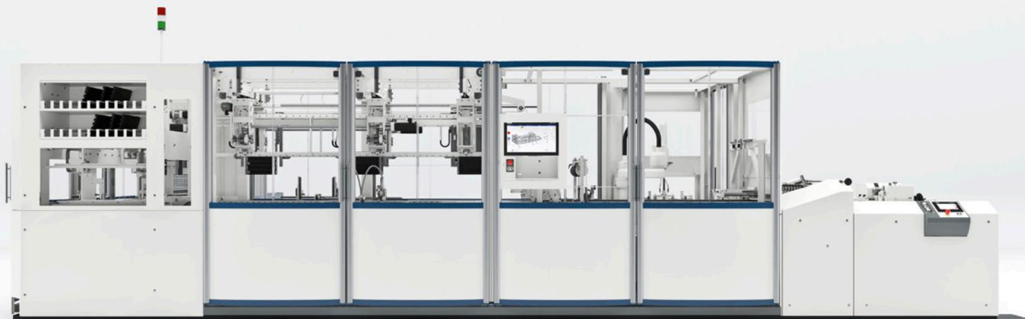
BLW 200 – Regal mit Formplatten (links), bedienergeführte Produktionswechsel per Copilotsystem (Mitte rechts)
